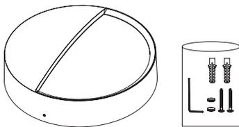
3. Befestigen Sie das Rückgehäuse mit den mitgelieferten Schrauben an der Wand oder Decke.
