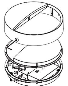
4. Definieren Sie die gewünschte Lichtfarbe beim DIP-Schalter und dann verbinden Sie die Kabel.
