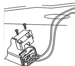
3. Verbinden Sie das Downlight mit dem Treiber, halten Sie den Federclip zurück und schieben Sie das Downlight in das Loch.
